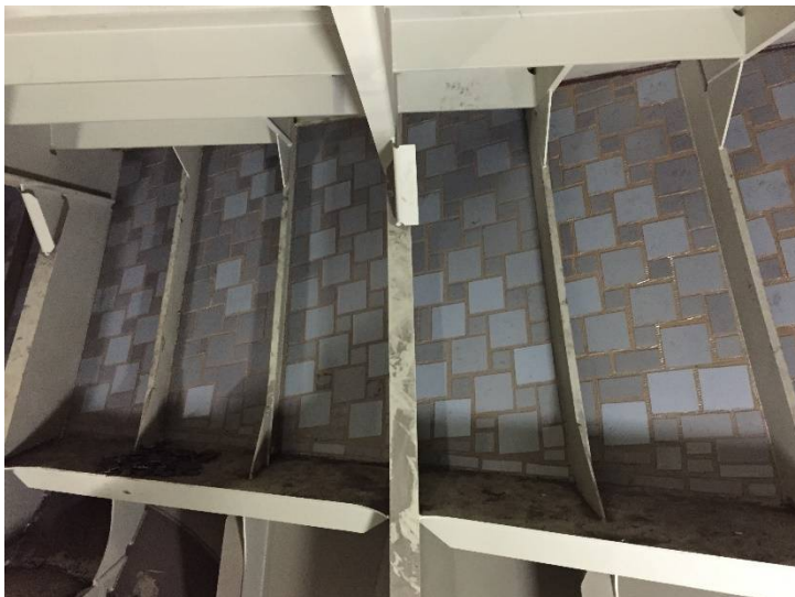
Soundac® PU-D30 gemonteerd op een scheepsromp
